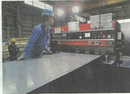
(社長は藤澤鋼板の藤澤雄会長が兼任)は、シャーリングマシンを1台新設し、1月中旬から本格稼働を開始した。SAPH440規格材で板厚6・5ミ、板幅1270ミまでに対応する。導入したのはメカニカルシャー「DCT-1265」(アマダ製)。
